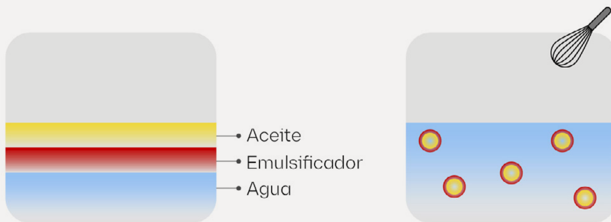
Figura 1. Representación esquemática de cómo se produce la emulsión (O/W).
