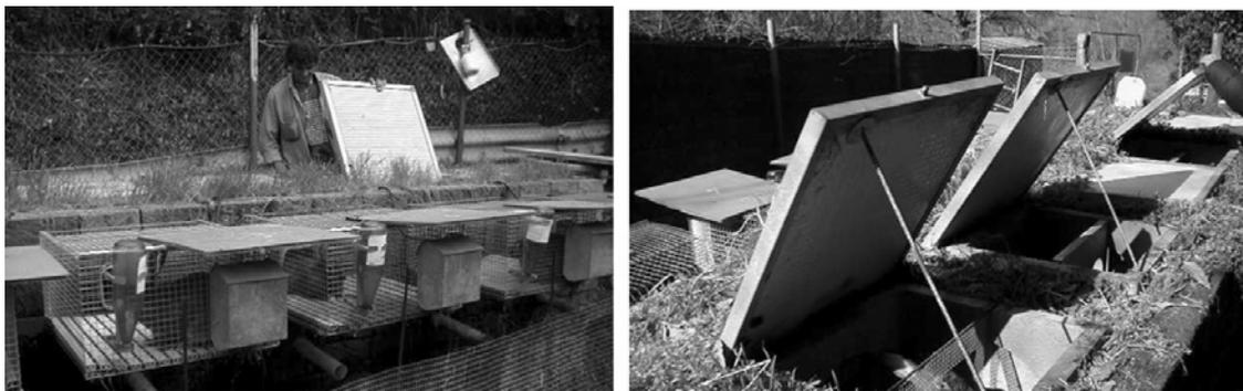
**Figura 4.** El primer prototipo de celda enterrada operativa.
