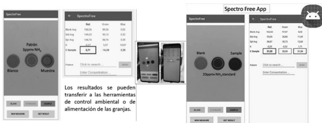
Figura 2. Ejemplos de capturas de pantalla de resultados de amoníaco obtenidos a través de la aplicación SpectroFree/MINTOTA.
